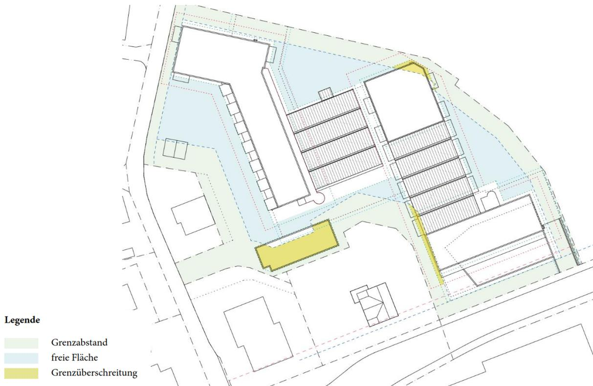
Abbildung 17: Schema mit den Über- und Unterschreitungen der Grenzabstände
