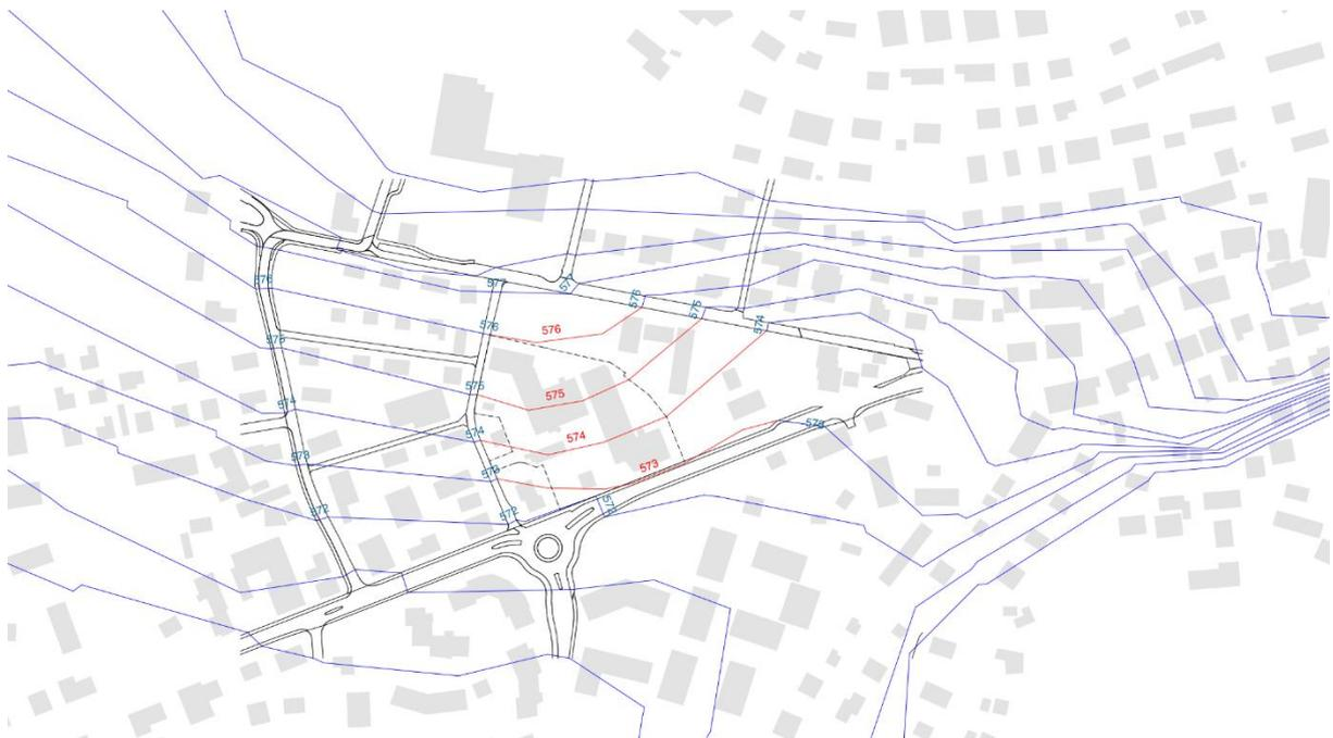
Abbildung 14: Neues massgebendes Terrain (rote Höhenlinien) anhand der umliegenden Strassenhöhen
